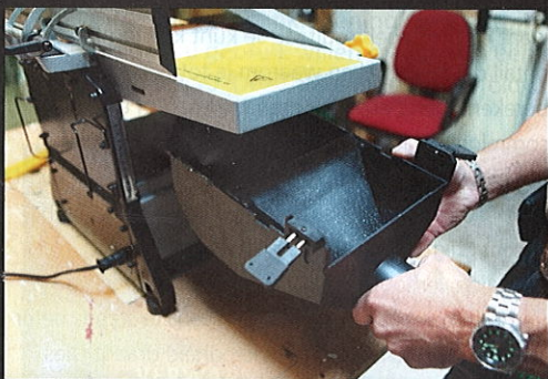
De spaanopvangbak past in de vandiktebank...
