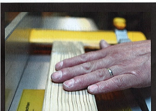
De beitel maakt met 8000 toeren een glad huidje op een regel van tuinhout.
